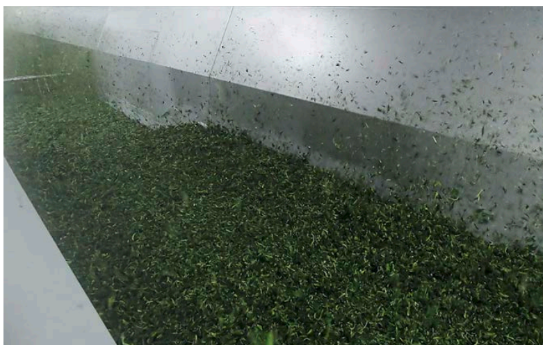
Fließbettfroster, wie hier der Blizzard von Heinen, werden meist dann eingesetzt, wenn Schüttgut gefrostet werden soll.
